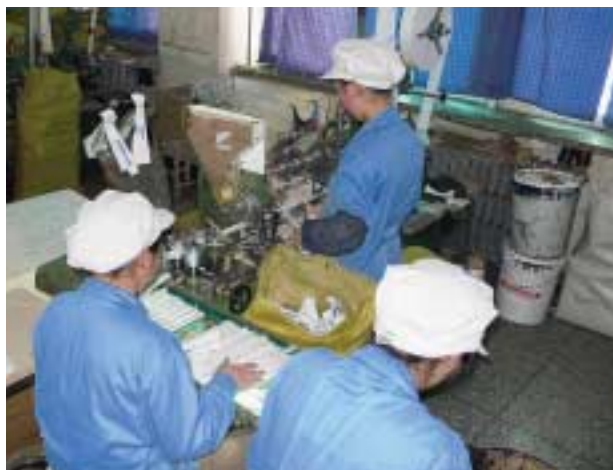
割り箸の包装及び検品現場 (下から光をあて異物混入の有無を確認)
